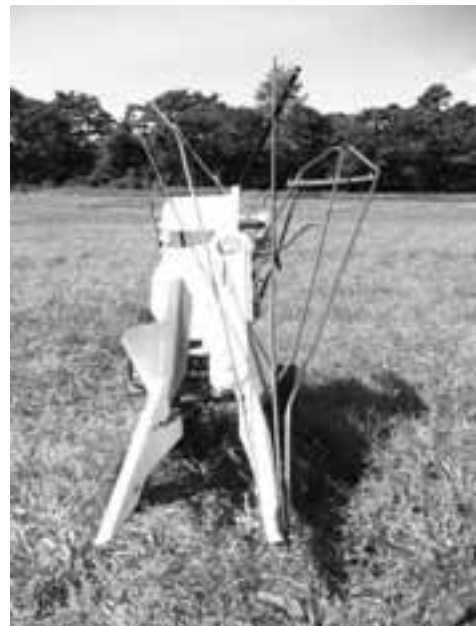
図3 改造後の雑穀バインダ (正面)
