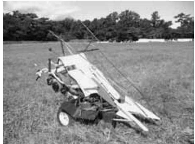
図2 改造後の雑穀バインダ (側面)
