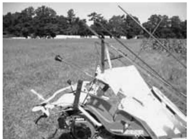
図4 改造後の雑穀バインダ (茎稈排出棒)
